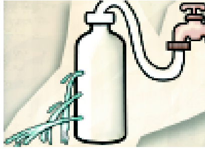
Figura 2. A ilustração mostra incorretamente jatos d'água que saem de um recipiente a distâncias cada vez maiores quanto mais próximos os furos estiverem do chão. O erro pode ser apontado fazendo um furo rente ao chão. Este não alcançaria a maior distância possível como supõe a falsa experiência
